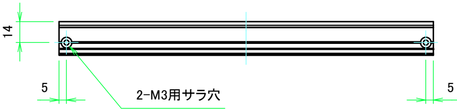
2-M3用サラ穴 2-M3 Countersunk ※反対面も同様 / Same on the other side.
