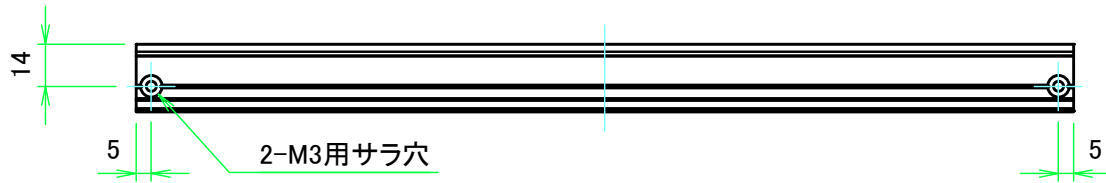
2-M3用サラ穴 2-M3 Countersunk ※ 反対面も同様 / Same on the other side.
