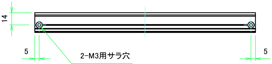
2-M3 Countersunk ※反対面も同様 / Same on the other side.
